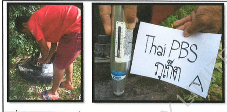
รูปที่21 ภาพตรวจความแข็ง (Strength) ของคอนกรีตฐานราก A=460 KG/CM 2
